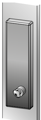
Verrouillage / déverrouillage manuel avec clé ou bouton tournant intérieur et extérieur
